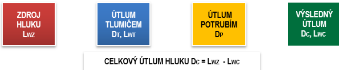
Obrázek 16: Zatlumení VZT jednotek – koncepce výpočtu
